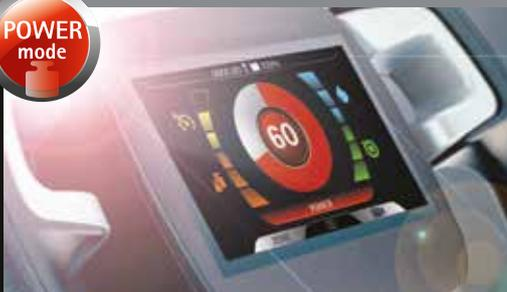
Cuando se necesita una mayor fuerza de fregado puede activarse el Power Mode, que aumenta el caudal de la solución detergente, la presión y la potencia de aspiración, por el tiempo necesario para enfrentar situaciones de limpieza profunda
