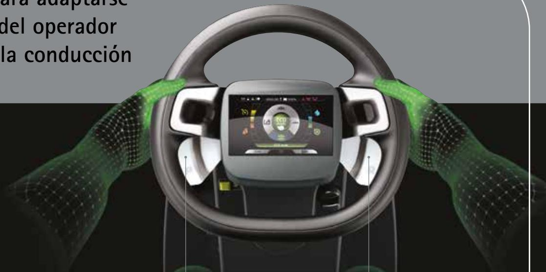
Las paletas laterales aumentan el control sobre la máquina y garantizan una conducción cómoda y segura
