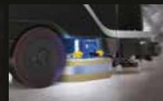
El exclusivo paquete de luces para el mantenimiento aumenta la visibilidad de las partes que podrían requerir un control por parte del operador, iluminando las zonas interesadas con luces de LED
