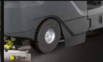
Kit de ruedas superelásticas delanteras y traseras para reducir al mínimo los esfuerzos y aumentar el confort
