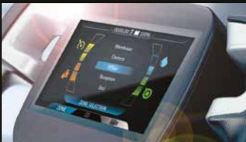
Para alcanzar siempre los estándares de limpieza que se desean, evitando alteraciones, el supervisor puede memorizar diferentes tipos de ambiente para asociar a éstos parámetros de limpieza diferenciados. El operador debe seleccionar únicamente la zona que debe limpiar para tener una configuración de trabajo ya fijada y con los ajustes correctos
