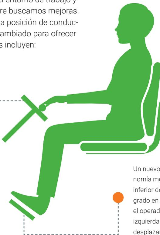
Mover la pared trasera de la cabina más hacia atrás ha hecho posible mover el asiento del conductor 3 cm hacia atrás para aumentar el espacio para el operador. En conjunto, estos dos cambios han aumentado el espacio para el conductor en 7 cm, lo que se traduce en una sensación de cabina mucho más espaciosa y de mayor comodidad para el operador.
