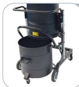
El material aspirado se recolecta en un contenedor robusto. Detrás del aspirador hay un mango metálico que permite bajar el contenedor. El contenedor puede ser desplazado fácilmente porque lleva 4 ruedas industriales pivotantes. Cada rueda se encuentra en un chasis reforzado para garantizar la mejor estabilidad aun si el contenedor está lleno.
