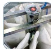
El sistema PSC es un sistema automático de sacudir. Dentro de la cámara del filtro hay un pistón neumático que sacude el filtro cada vez que el operador empuja el botón de activación. En opción es posible instalar un PLC para obtener un ciclo completamente automático.
