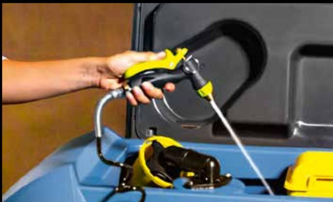
La pistola spray tiene una doble función. En la fase de mantenimiento de la máquina facilita el enjuague de los tanques al final del turno, mientras que, durante la intervención, se puede utilizar para humedecer las manchas de suciedad adherente y facilitar su eliminación.
