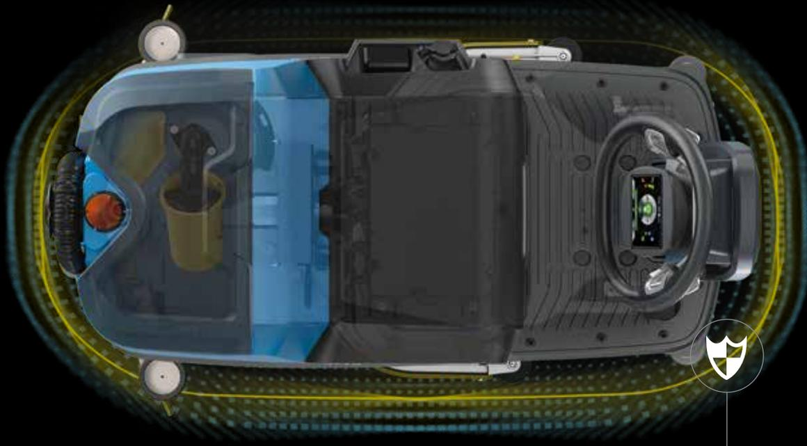
La estructura de polietileno no deja ninguna parte descubierta y todos los componentes quedan protegidos en su interior.
